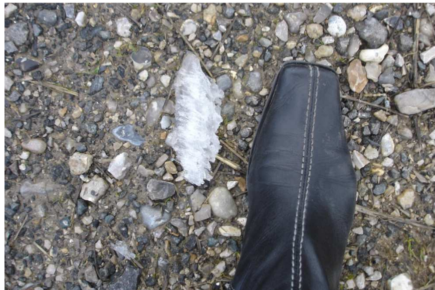
Photo prise dans une période de formation de givre, un seul morceau de quelque cm est trouvé au pied du mât de l'éolienne n° 2 du parc de Mont Bergeron 1.
